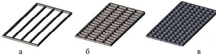
Рис.1. Конструкції ріжучо-перемішуючих пристроїв: а – з вертикальними пластинами, б – з комітками прямокутної форми, в – з комітками квадратної форми
