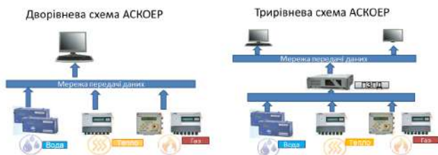
Рис.1. Дворівнева та тривірнева схема АСКОЕР
