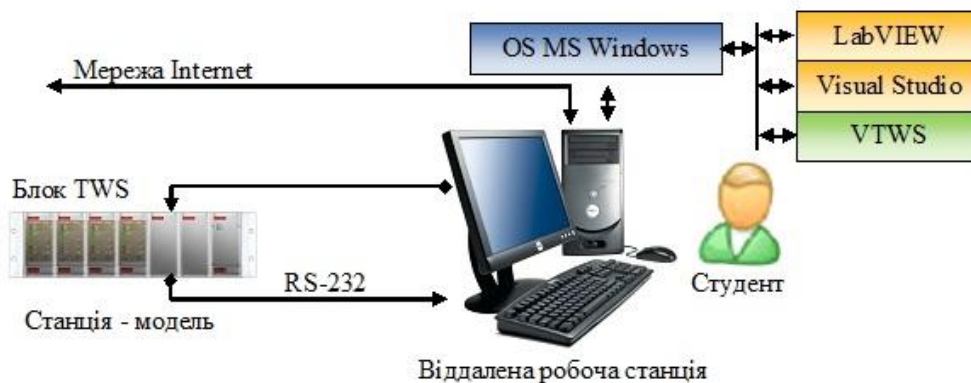
Рис. 2. Віддалена робоча станція з фізичною моделлю
