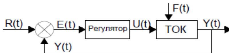
Рис. 1. Системи керування елементарним тепловим об'єктом: R(t) – завдання системи, E(t) – величина неузгодженості, U(t) – керуючий вплив, F(t) – збурювальний вплив, Y(t) – значення контролюваного параметру.
