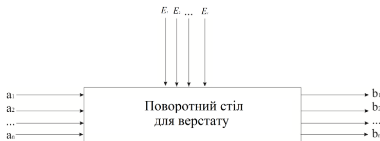
Рис. 1 Поворотний столу верстату як об'єкт керування
