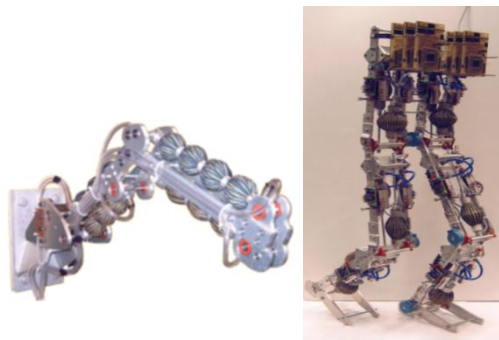
Рис.3 Применение гофрированных пневмомыщ в робототехнике
