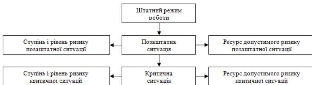
Рис.1: Структурна схема взаємозв'язків показників ризику з компонентами даної ситуації
