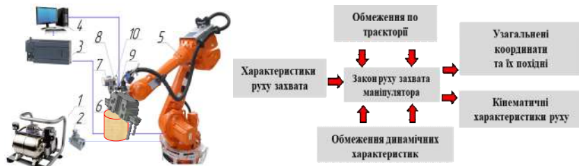
Рис. 1. Функціональна схема експериментальної установки і узагальнений алгоритм дослідження 1 - компресор, 2 - пневмодросьель, 3 - контролер, 4 - персональний комп'ютера, 5 - промисловий робот, 6 - орієнтуючий подовжувач кінцевої ланки, 7 - пневмозахоплюючий пристрій, 8 - пластина, 9 - датчик відриву, 10 - захисні елементи
