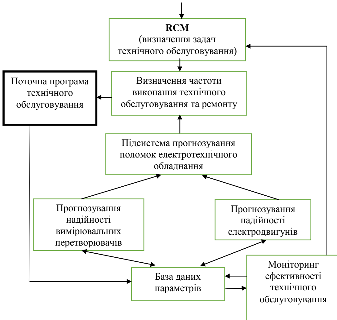
Рис.1. Структура системи реалізації програми технічного обслуговування
