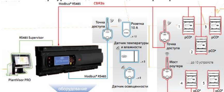
Рис.1. Приклад схеми підключення споживачів
