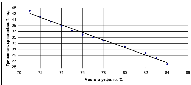
Рис. 1. Залежність терміну політермічної кристалізації в перемішувачах-кристалізаторах від чистоти утфелю після його вивантаження з вакуум-апарату
