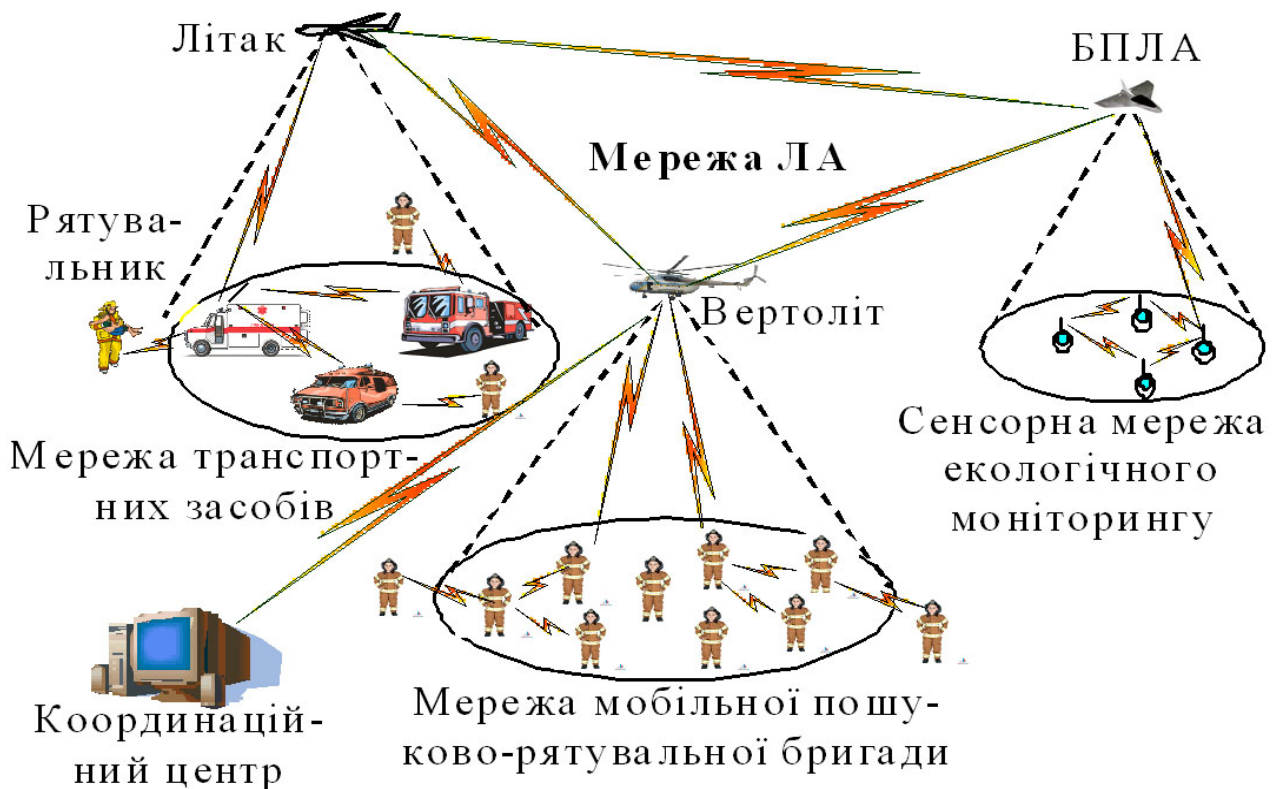
Рис. 1. Приклад організації мобільної епізодичної мережі моніторингу НС із використанням повітряних ретрансляторів
