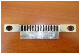
Рис. 1. Напрямна рамки шпигорізці після 1000 годин експлуатації
