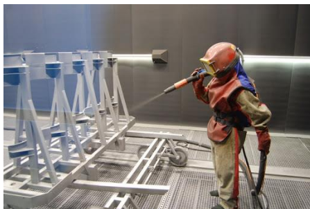
Рис. 1. Піскоструменеве очищення металевих поверхонь у спеціальній камері
