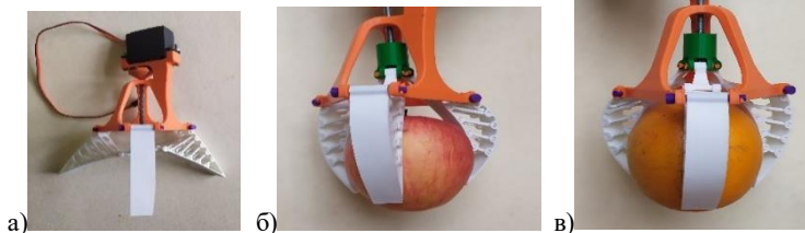
Рис.1. Трьохпальцевий захоплювальний пристрій типу MultiChoice:
