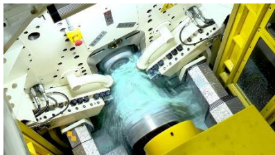
Рис. 1. Ротаційне протягування апаратом Repkon RFFM 330-138-300 CNC
