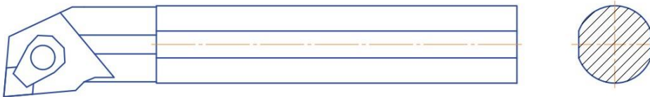
Рис. 1. Розточний токарний різець марки S32X-MCLNL 12-Bh 12
