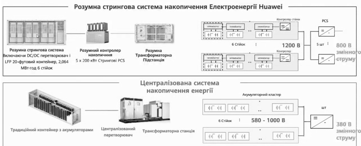
Рис.2 Усунення некерованості та невідповідності літєвих акумуляторів. Smart String ESS
