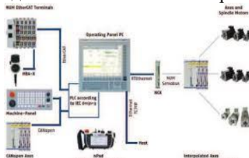
Рис. 1. Загальна схема Flexium ЧПК
