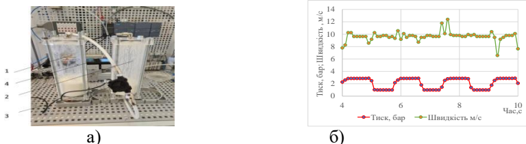
Рис. 1. Експериментальний стенд для дослідження дозувальних ерліфтних модулів: а) загальний вид експериментальної установки; б) графіки зміни основних параметрів системи: 1 – ресивер подачі продукту ( під тиском 1,5 бара); 2 – графіки досліджуваних параметрів; 3 – витратомір; 4 – контрольно-вимірювальний блок із датчиками тиску.
