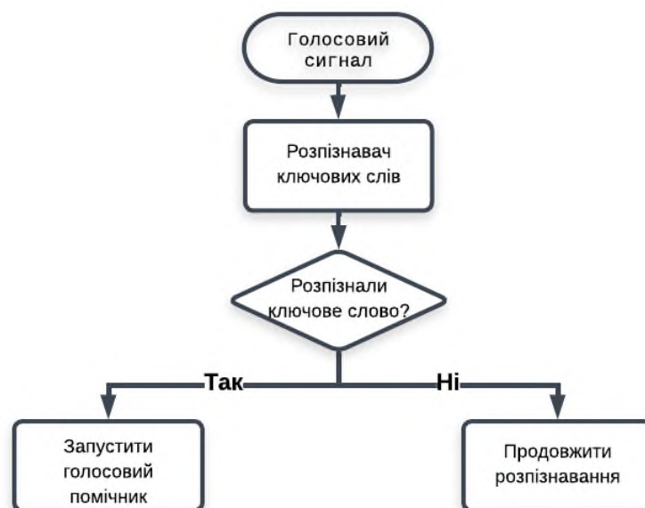
Рис. 1. Типова схема використання розпізнавання ключових слів в голосовому сигналі
