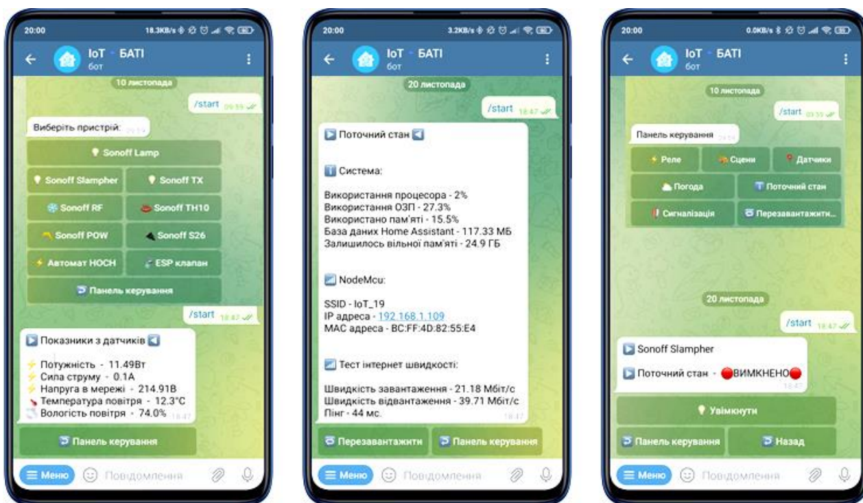
Рис. 2. Керування електричними пристроями через Telegram-бота
