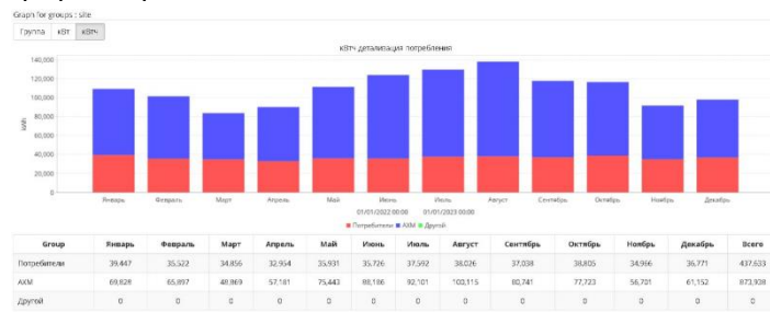
Рис. 2. Графік енергоспоживання холодильним обладнанням після модернізації
