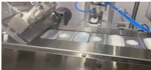
Рис. 2. Вузол подачі у блістерній машині
