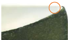
Рис. 2. Приклад утворення J подібних зачепів на кромці пуансона
